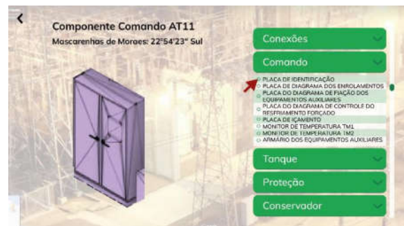
Fig. 5b: Interface de operação do ativo na Unity Engine trazendo o modelo BIM e parâmetros em CSV. Fonte: Autores (2023).
